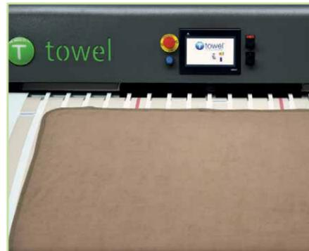
Die Artikel werden auf das Eingabeband gelegt. Dieses Förderband beginnt zu laufen, sobald das Artikel detektiert wird oder nach einer manuellen Aktivierung mittels einer Taste auf der Seite der Maschine.
