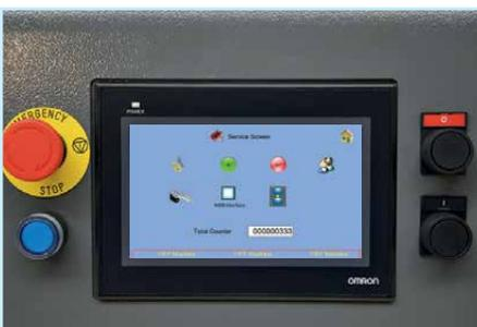
Die **t.Towel** hat eine PLC-basierte Steuerung. Die Bedienung der Maschine erfolgt mittels eines gebrauchsfreundlichen 7" Farb-Touchscreen. Die Steuerung benötigt eine hohe Rechenleistung und deshalb hat sich TEXTFINITY für OMRON entschieden.
